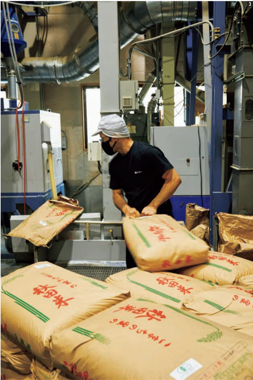
1 奥に見えるのが「フレコン」と呼ばれる1トン単位の袋。精米所では30kgずつの袋約34本にばらします。これもまた力仕事。 2 有機米の精米所内、選別機の奥にある精米機。管を継ぎ足して今の形になりました。 3 米袋をおろして玄米を投入します。足元の床に四角い穴があり、そこが精米の入口。
