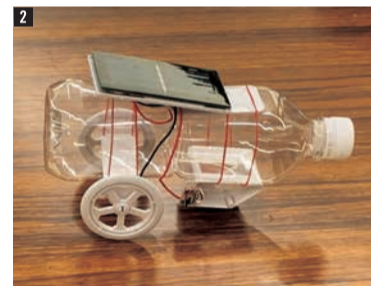
1 いざざい、ソーラーカー！！ 2 ペットボトルを利用した手作りソーラーカー。太陽光を受けてトコトコ走ります。
